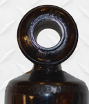
Soldadura de arco a 360°
